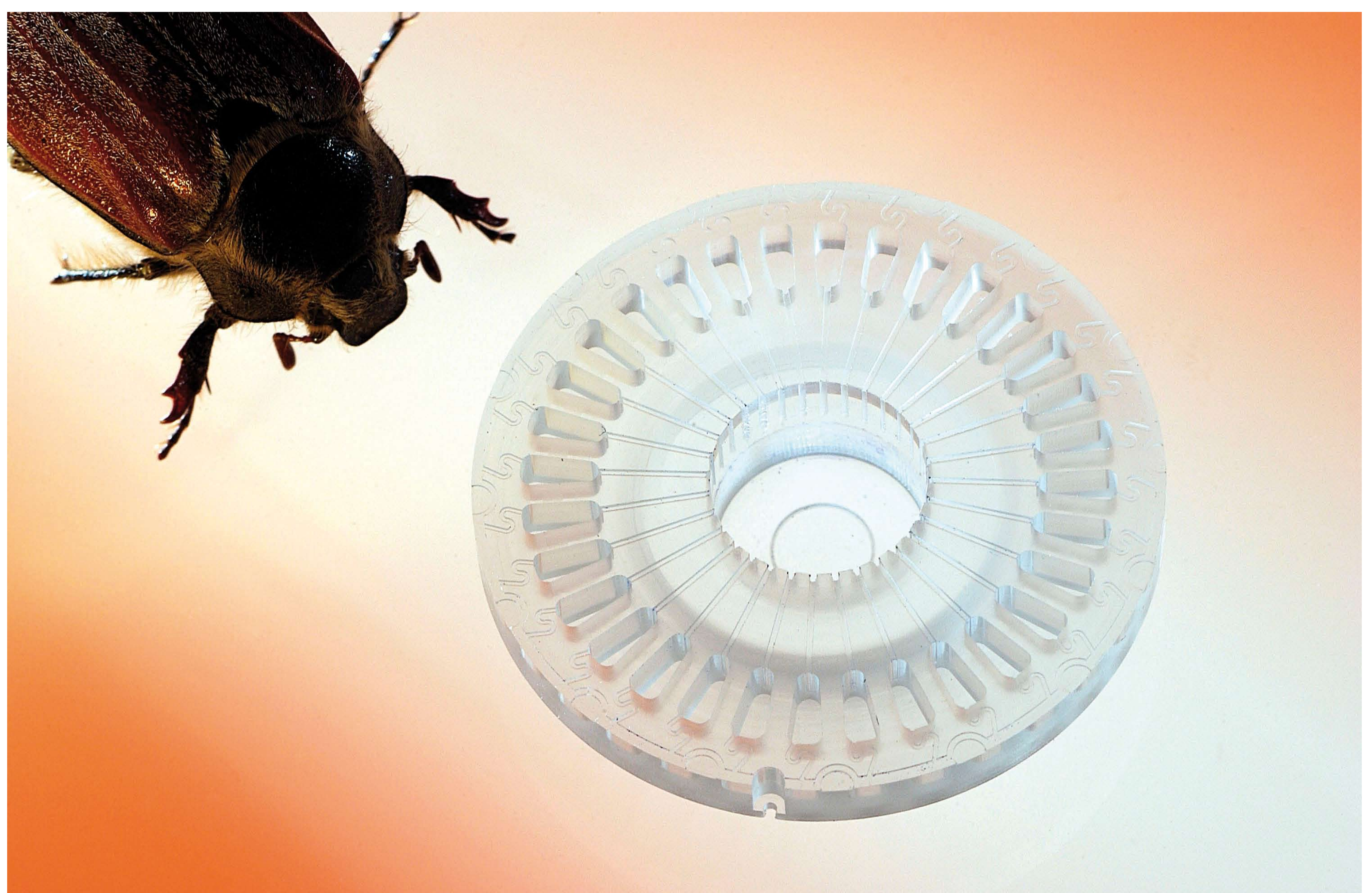
Abb. 1: Das Bio-Analysesystem BioDisk hat die Größe eines 2-Euro Stückes und bietet 32 Reaktionskammern. Bild Forschungszentrum Karlsruhe
