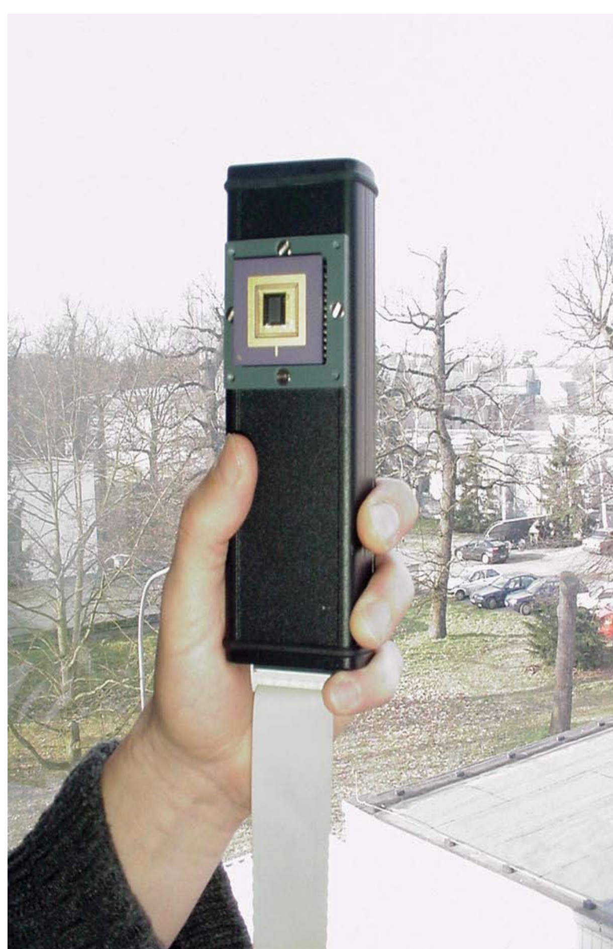
Abb 2: Die Mikronase KAMINA als kompaktes Handgerät (Prototyp). Bild: Forschungszentrum Karlsruhe
