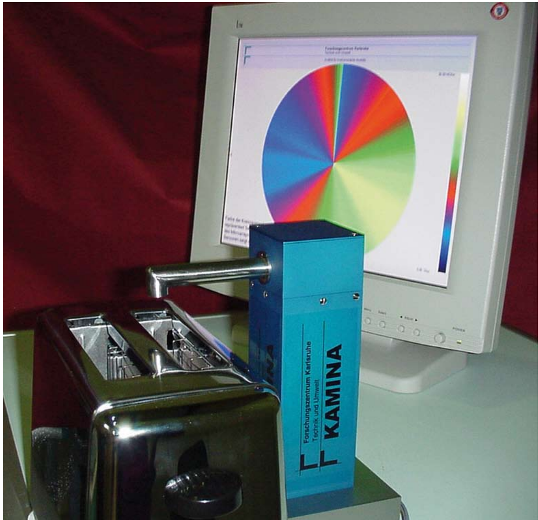
Abb 3: Funktionsdemonstration von KAMINA zur Überwachung eines Brotrösters. Im Hintergrund die farbliche Visualisierung der aufgenommenen „Gerüche“. Bild: Forschungszentrum Karlsruhe
