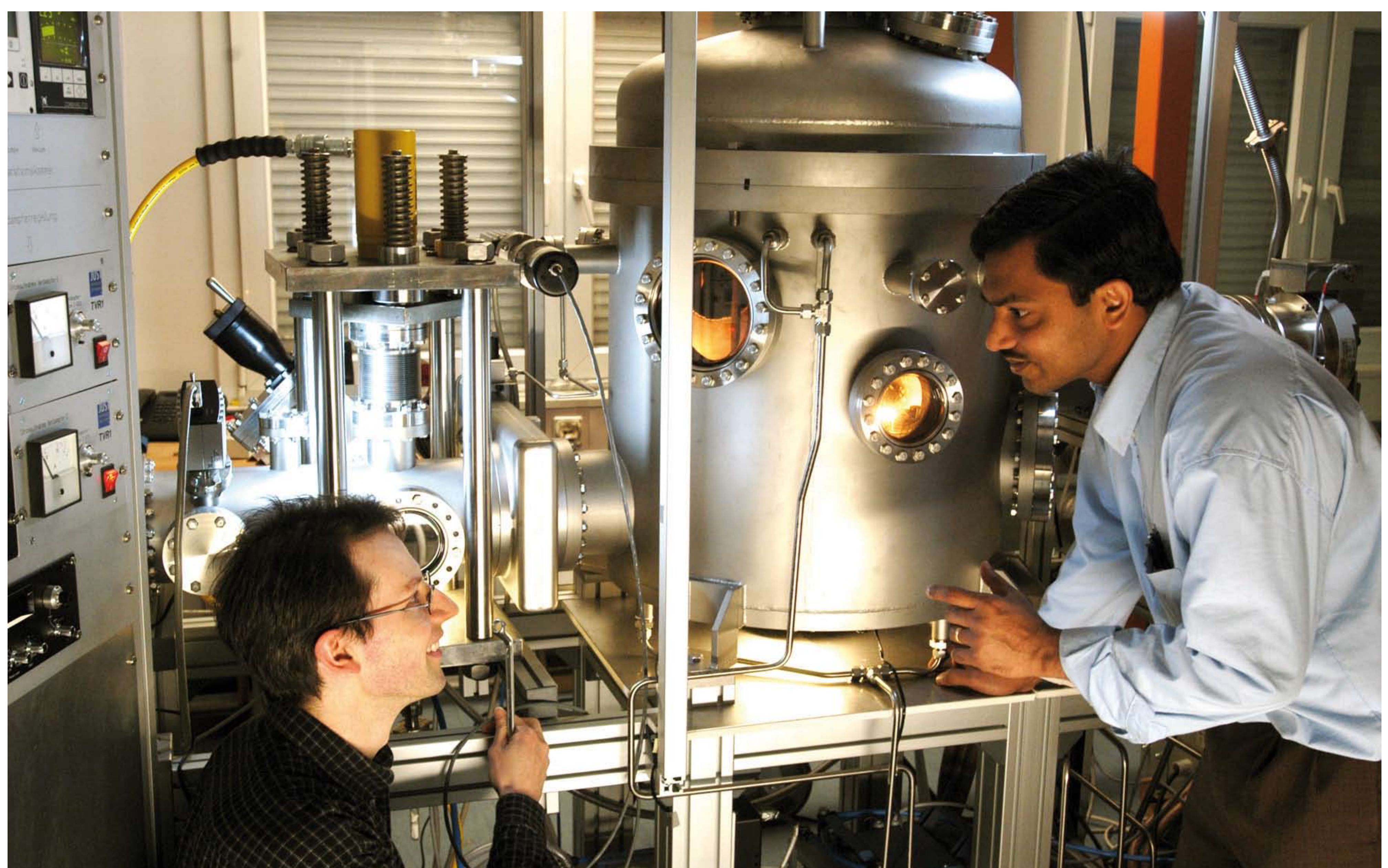
Abb. 1: Edelgaskondensationsanlage zur Herstellung nanostrukturierter Partikel, beispielsweise aus Platin. Bild: Forschungszentrum Karlsruhe
