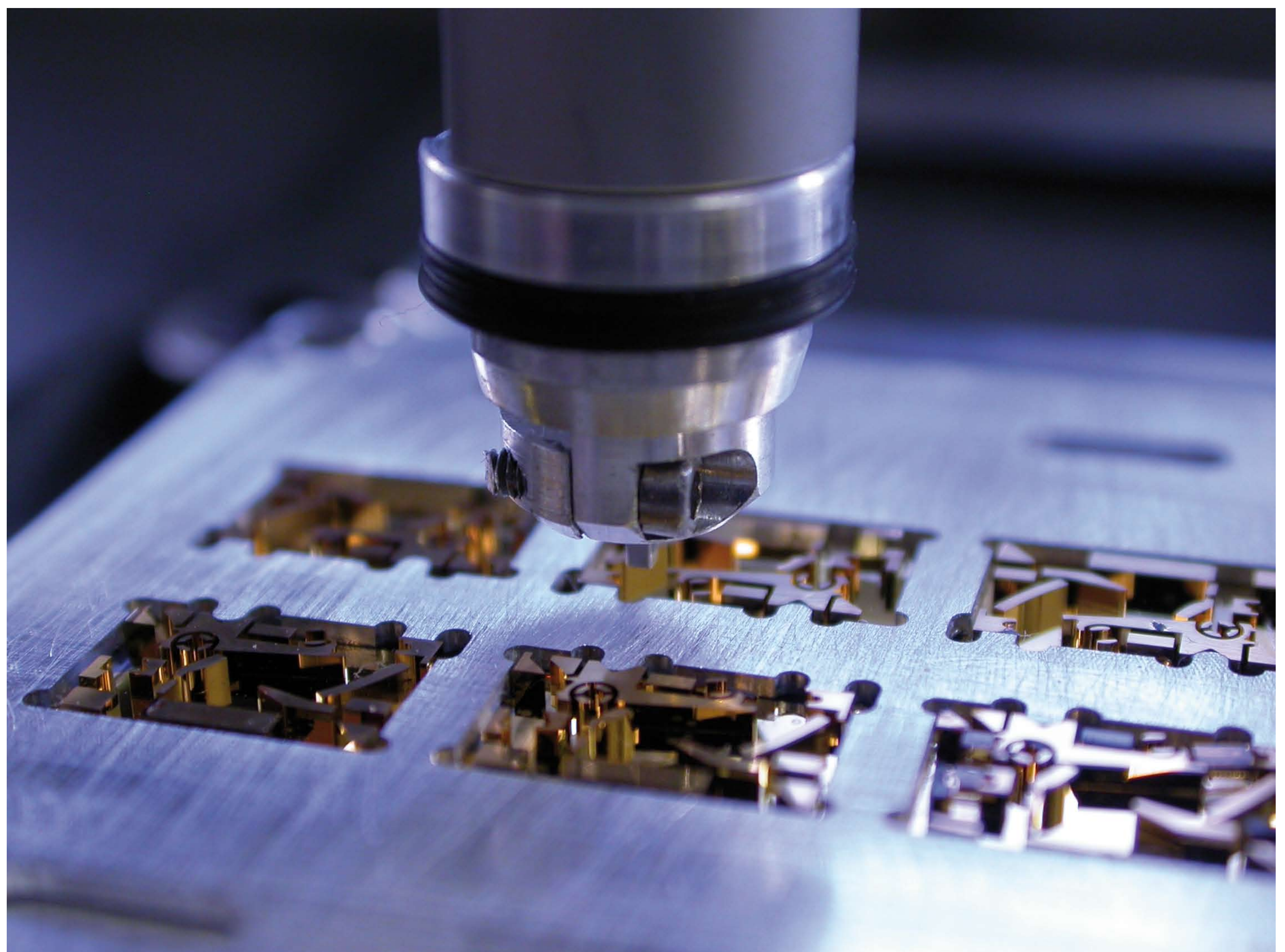
Abb. 3: Montage der Mikrolinse in der Mikrooptischen Bank. Bild: Forschungszentrum Karlsruhe
