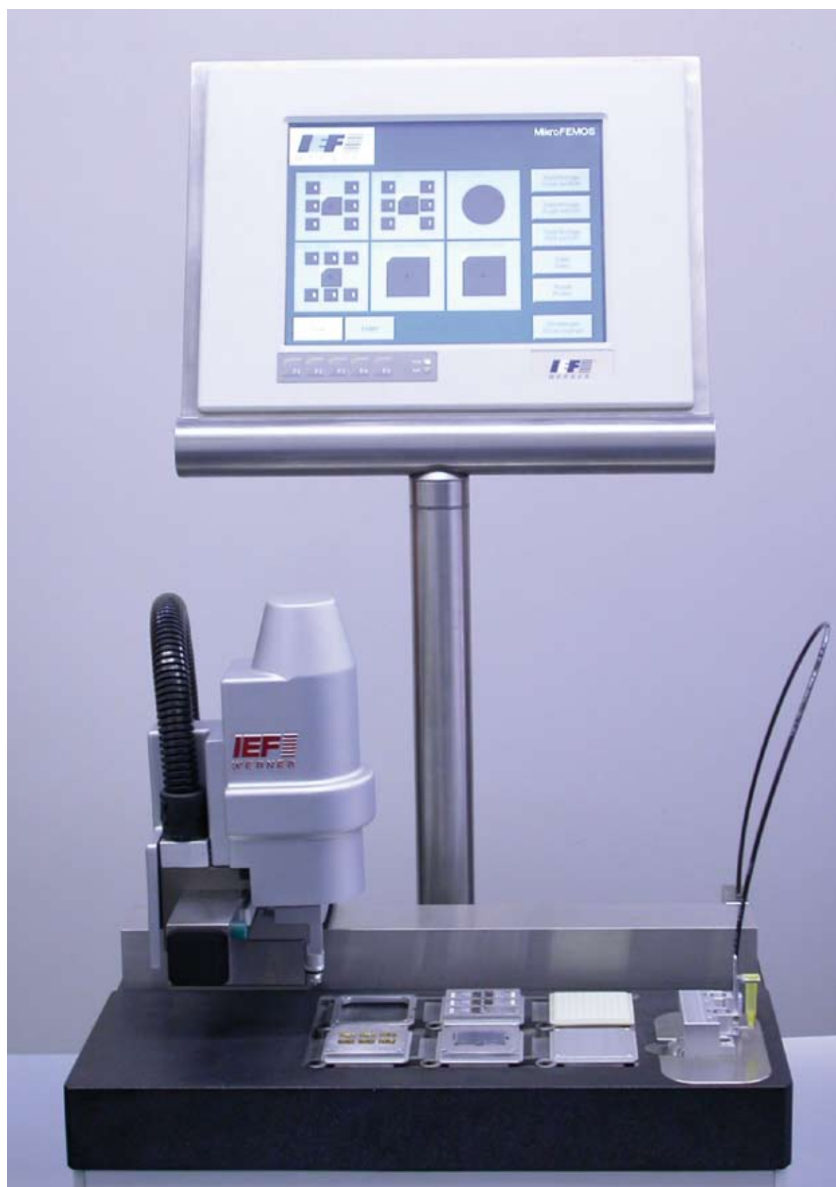
Abb. 1: Mikromontagesystem Mikro-FEMOS des Forschungszentrums Karlsruhe auf Basis des Achssystems nanoline der Fa. IEF Werner, Furtwangen. Bild: Forschungszentrum Karlsruhe
